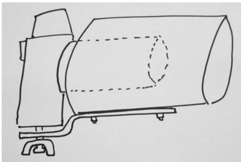
El corazón del flash es un tubo de 10cm de diámetro de PVC: barato, resistente, fácil de cortar y disponible en cualquier lugar. La cámara se monta mediante una pletina de aluminio doblada con ayuda de una mordaza.
