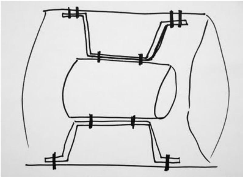
El tubo PVC se conecta con un tubo exterior de 40cm de diámetro hecho de masonite (*N. de T.: tubo de cartón reforzado que se utiliza en las obras para el encofrado de hormigón*). Este material es muy resistente. Puedes taladrarlo y montar tornillos con tuercas y arandelas. Lo soporta perfectamente.
