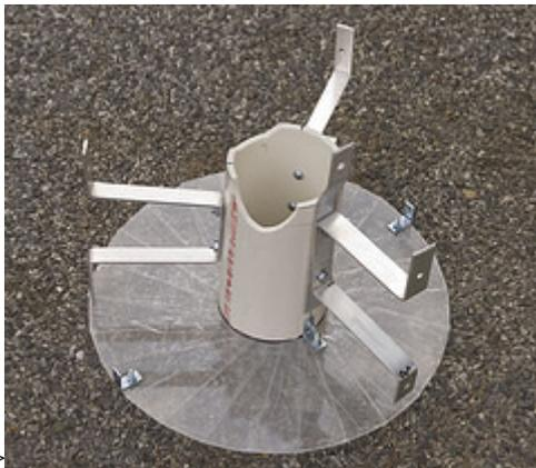
> En esta otra imagen se puede ver como está montado el tubo de PVC, con sus soportes de aluminio doblados a mano, sobre la pieza de plexiglas. Cuando elijas el diámetro del tubo de PVC, ten en cuenta que además del diámetro del objetivo tienes que dejar hueco para las cabezas de todos estos tornillos. No lo ajustes demasiado.
