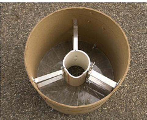
Aquí puedes ver como los soportes radiales que he montado en el tubo de PVC se unen al tubo de encofrado exterior generando una estructura muy resistente. La verdad es que el montaje ha resultado mucho más sencillo de lo que me esperaba.
